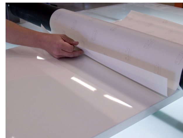
12. Saisissez le liner que vous aviez replié sous le cylindre de l'autre côté. Déplacez le portique coulissant au-dessus de la surface. Veillez toujours à ce que le décor se trouve contre le cylindre de pression dès le départ.
