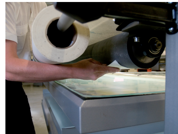
3. Captar la cinta adhesiva de aplicación debajo del rodillo ...
