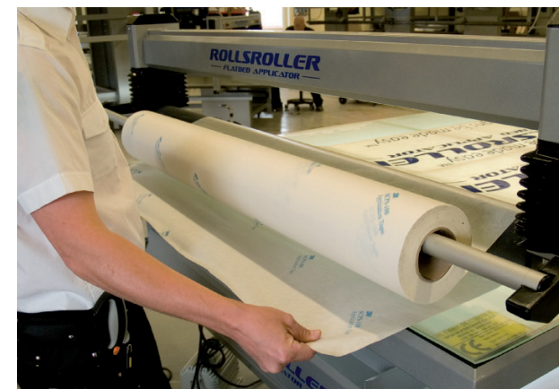
4.... e allinearla con il margine della bobina per garantire un'applicazione lineare.
