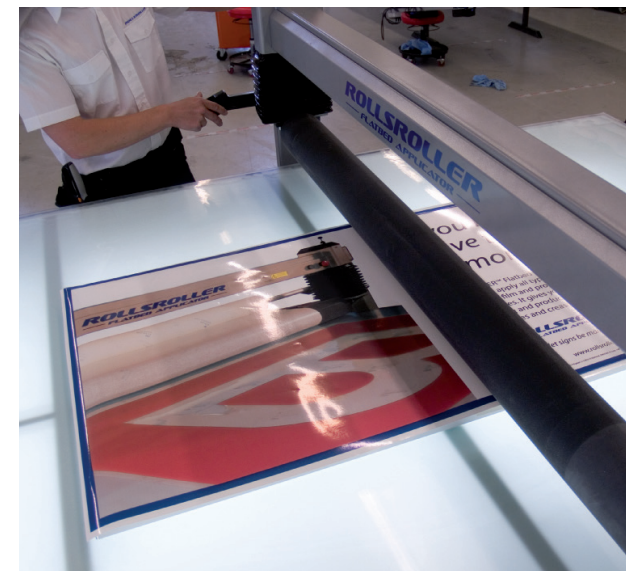
10. Positionnez le portique coulissant à hauteur de la découpe du liner, puis actionnez le cylindre.
