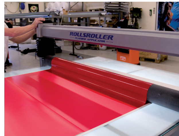
9. Aplicar una mitad de la hoja utilizando el rodillo. Comprobar siempre que la decoración está en contacto con el rodillo al arrancar.
