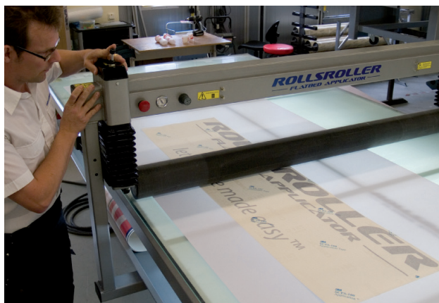
3. Beaufschlagen Sie die Walze mit Druck, um das Dekor zu fixieren.
