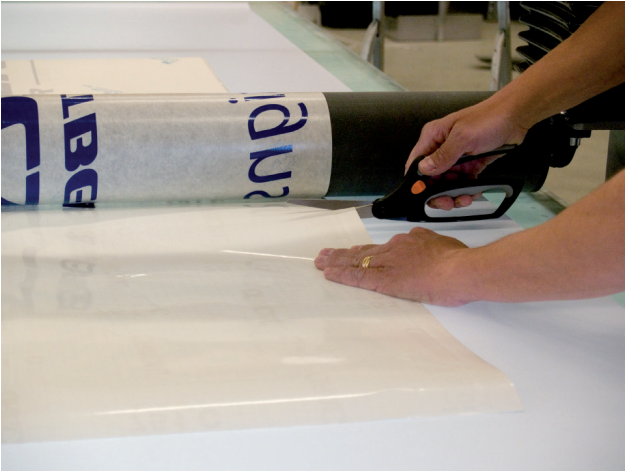
6. Découpez le liner à environ 10 centimètres du cylindre.
