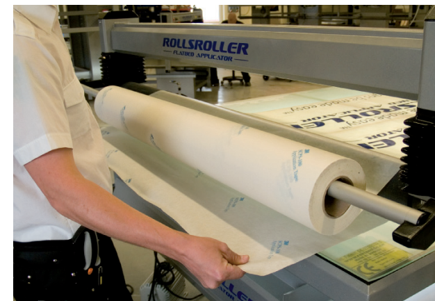
4. .... et veillez à ce qu'il se positionne bord à bord avec le rouleau, afin de garantir une application droite.
