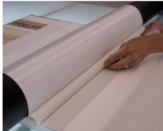
8. Den Überstand der Schutzfolie in einem gleichmäßigen Bogen unter die Walze einstecken (siehe Abb.).
