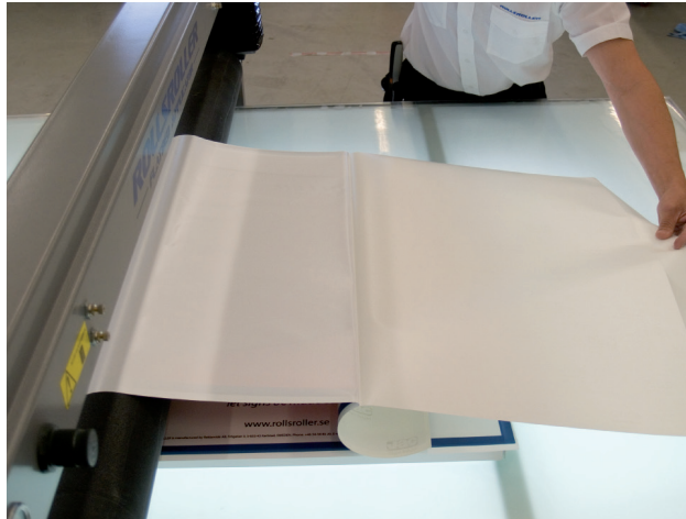
13. Fijar el resto de la decoración contra la base usando el rodillo. No olvidar elevarlo un poco al llegar al borde.
