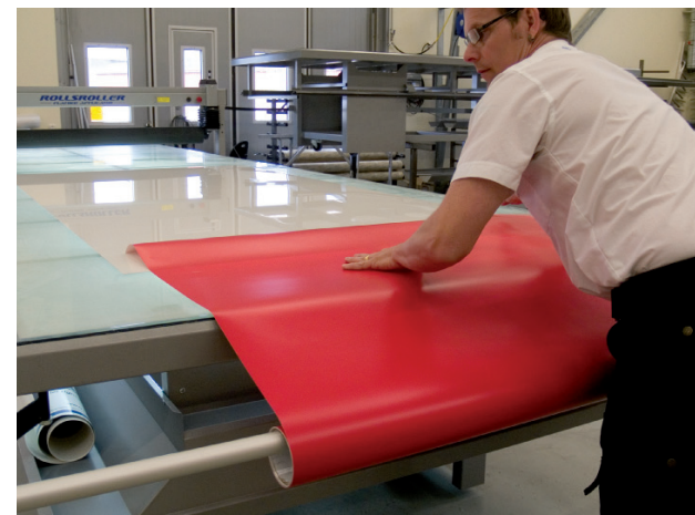
1. Centrez le support à laminer sur la table et déroulez le film PVC sur le support.
