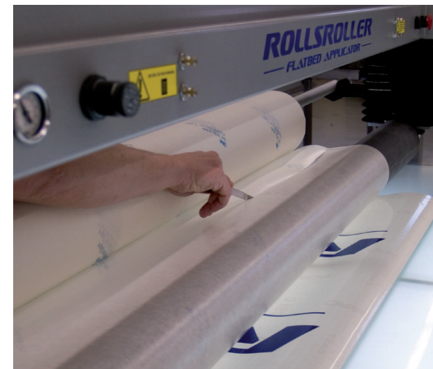
9. Découpez avant d'appliquer la dernière partie du film de montage. Si vous devez appliquer plusieurs décors en même temps, relevez le cylindre et répétez la même procédure que pour le premier.
