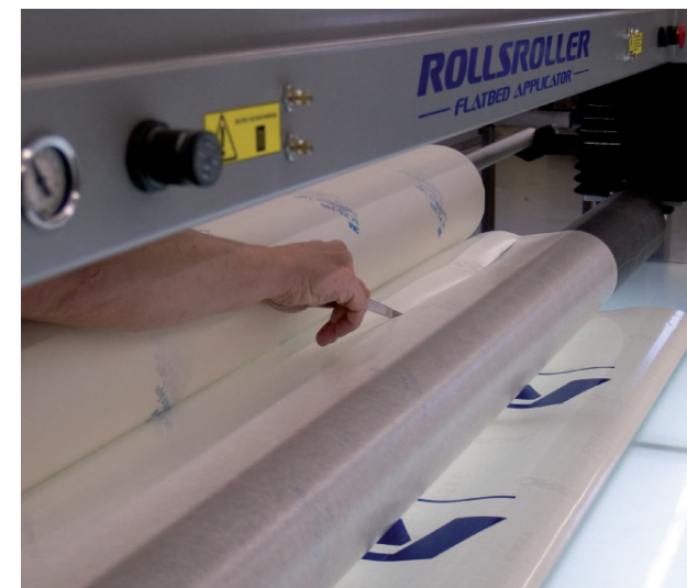
9. Recortar antes de aplicar el último trozo de cinta adhesiva. Si se van a aplicar varias decoraciones al mismo tiempo, elevar el rodillo y repetir el paso inicial que se hizo con la primera.
