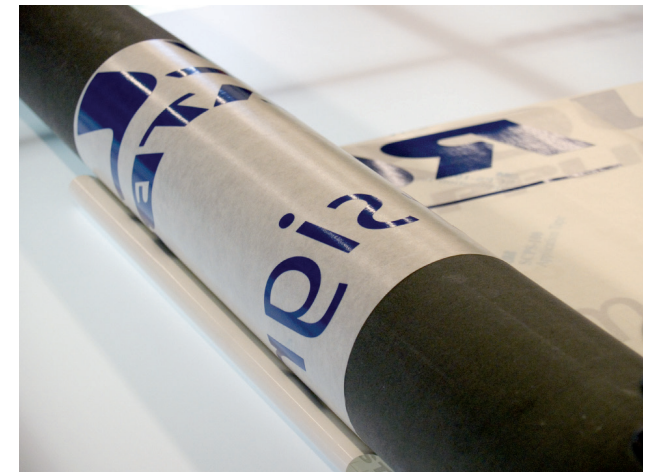
8. Die Hälfte des Dekors aufwalzen. Die Walze auf die Unterlage andrücken.
