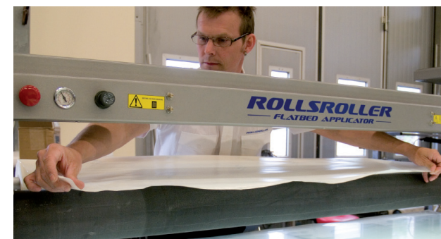
2. Déroulez le film de montage et repliez-le au-dessus du cylindre de pression.
