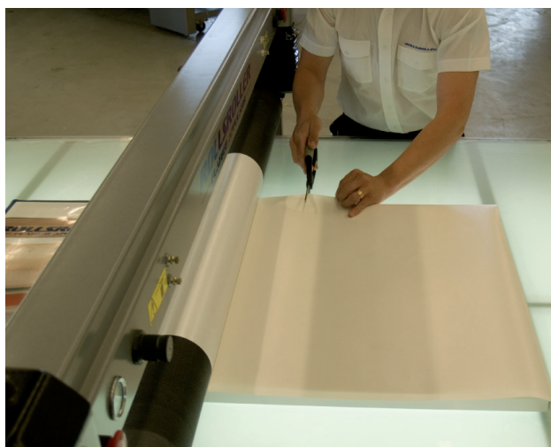
7. Cortar el revestimiento y guardar unos 10 centímetros.
