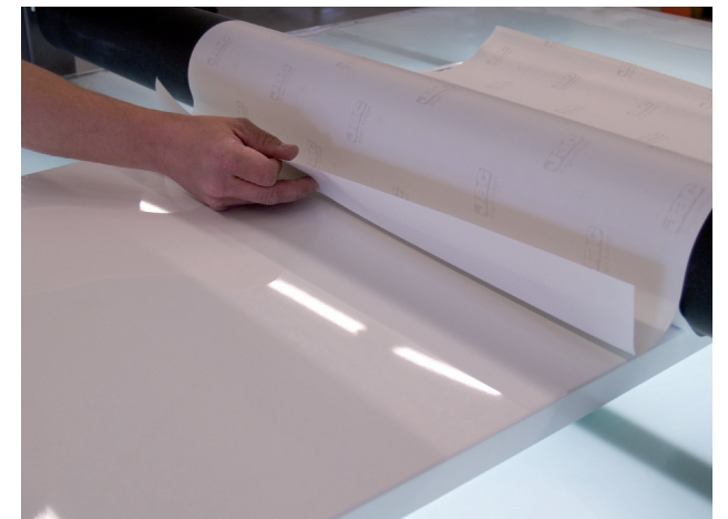
12. Ziehen Sie das Ende der Schutzfolie hervor, die Sie zuvor von der anderen Seite eingesteckt haben. Führen Sie den Gleitbalken über die Fläche und ziehen Sie gleichzeitig die Schutzfolie ab. Achten Sie stets darauf, dass bei Beginn der Bewegung das Dekor sauber an der Walze anliegt.
