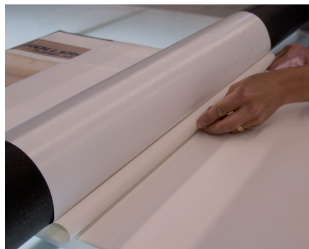
8. Doblar de vuelta el revestimiento debajo del rodillo para que forma un arco regular como en la imagen.
