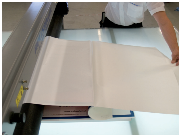
13. Appliquez la surface restante du décor sur le support à l'aide du cylindre. N'oubliez pas de relever légèrement le cylindre lorsque vous arrivez sur le bord du support.
