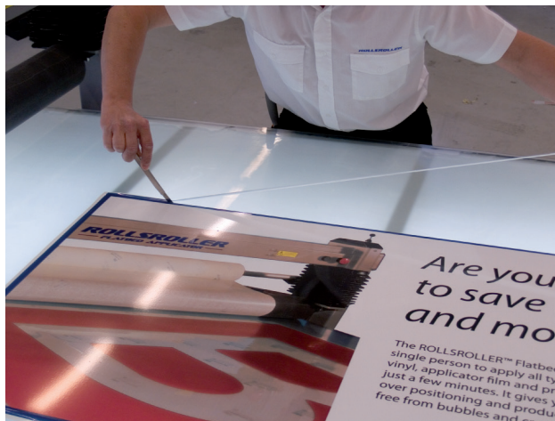
15. Eventuelle Überstände des Dekors abschneiden.
