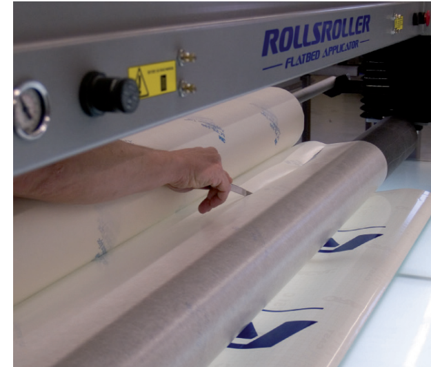
9. Vor dem Aufwalzen des letzten Stücks die Folie abschneiden. Falls Sie mehrere Dekors gleichzeitig aufbringen möchten, heben Sie die Walze an und wiederholen den Startvorgang wie bei ersten
