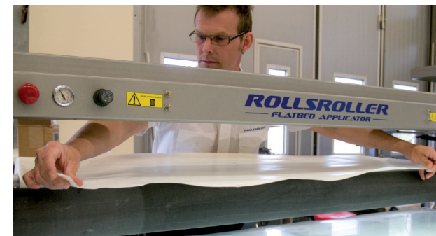
2. Sistemare l'Application tape lungo il rullo e piegarlo.
