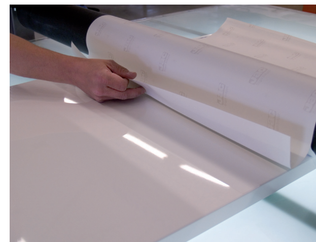
12. Tag fat i det stykke bagpapir, som du foldede ind fra den anden side. Før glidebommen hen over overfladen. Vær altid omhyggelig med, at printet ligger an mod valsens i starten.
