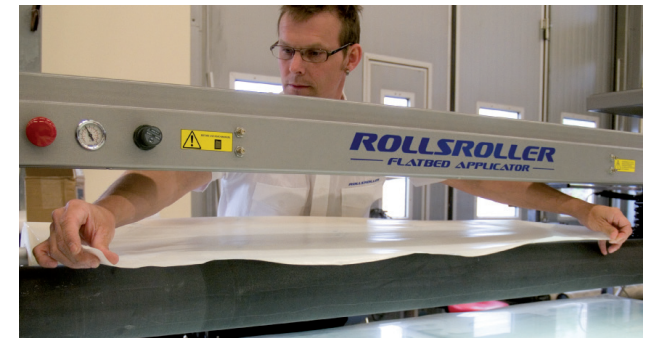
2. Extraer la cinta adhesiva de aplicación y doblarla sobre el rodillo.
