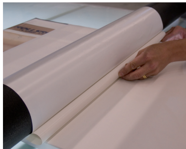
8. Repliez le liner sous le cylindre de sorte qu'il forme un arc régulier comme le montre l'image.
