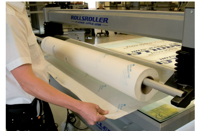
4. ... und darauf achten, dass sie kantengleich mit der Rolle zu liegen kommt, um geradlinigen Auftrag zu gewährleisten.
