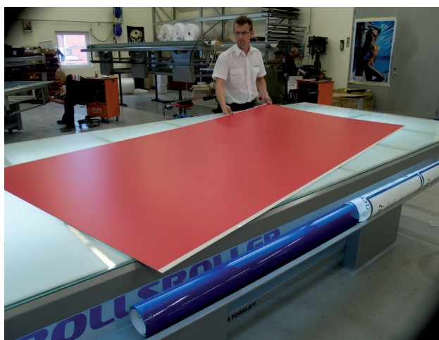
15. L'application du film/le pelliculage est terminé(e).
