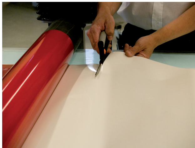
6. Cortar el revestimiento y guardar unos 10 centímetros.
