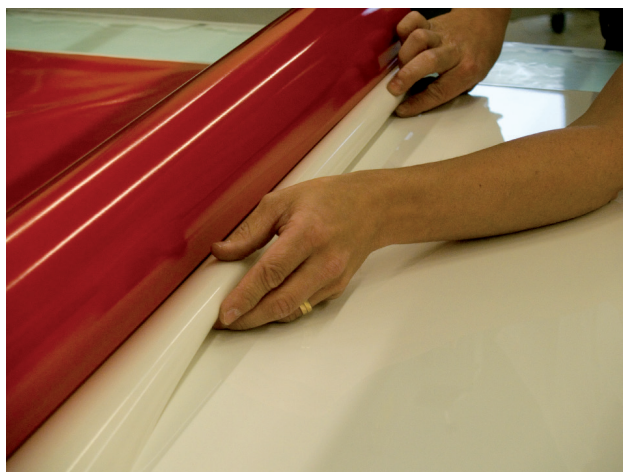
7. Repliez le liner sous le cylindre ...
