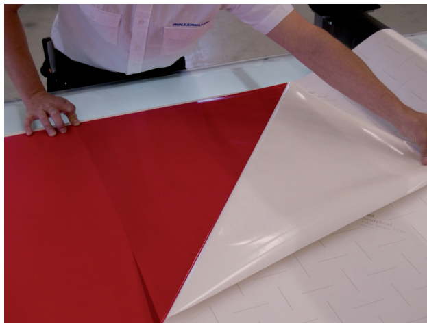
5. Retirez le liner du film en formant un angle de 45 degrés.
