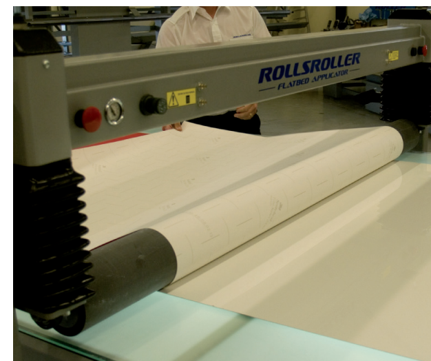
4. Repliez la moitié du film par-dessus le cylindre.
