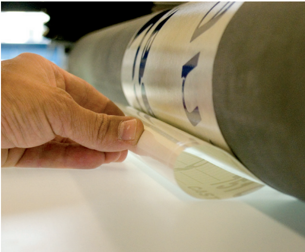
7. Doblar el revestimiento debajo del rodillo. Formar un arco regular.
