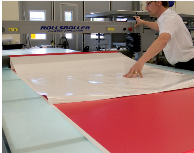
13. Walzen Sie nun die andere Hälfte der Folie auf die Unterlage auf. Achten Sie stets darauf, dass bei Beginn der Bewegung das Dekor sauber an der Walze anliegt.
