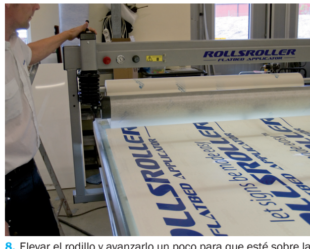
8. Elevar el rodillo y avanzarlo un poco para que esté sobre la decoración. Procurar que la decoración está plana cuando se presuriza el rodillo. A continuación, aplicar la cinta adhesiva sobre la decoración. Parar a unos 10 centímetros antes del final de la decoración.
