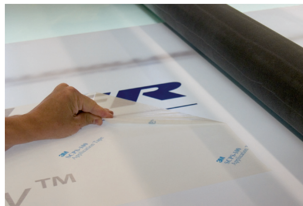
12. Rimuovere l'Application tape utilizzando il rullo per tenere saldo il supporto.
