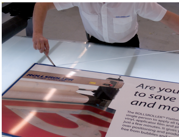
15. Skær rent, hvis printet er større end underlaget ...
