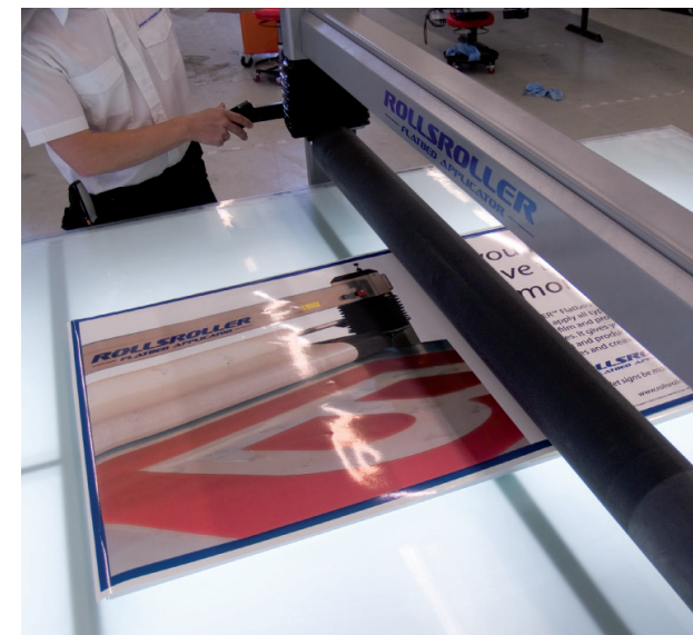
10. Posizionare il supporto mobile sopra il punto in cui il liner protettivo è stato tagliato. Fare scendere il rullo.
