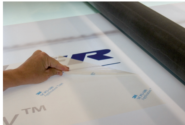
12. Ziehen Sie die Folie ab, während die Unterlage vom Walzendruck festgehalten wird.
