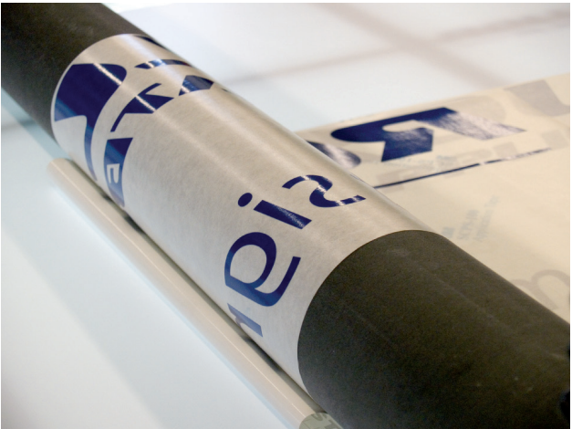
8. Applicer halvdelen af printet ved hjælp af valsen. Tryksæt valsen mod underlaget.
