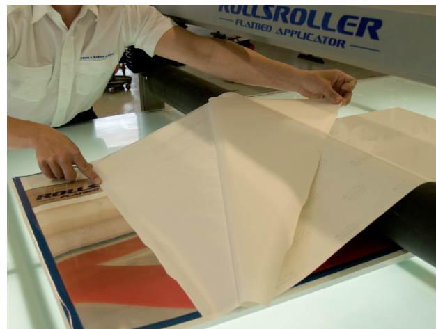
6. Quitar el revestimiento de la mitad colocada sobre el rodillo.
