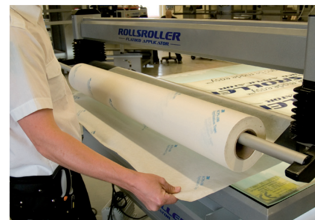
4. ...och se till att den hamnar kant i kant med rullen, för att säkerställa rak applicering.
