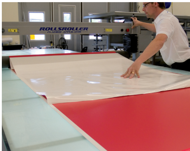
13. Applicer den anden halvdel af folien ved hjælp af valsen. Vær altid opmærksom på, at printet ligger an mod valsen i starten.
