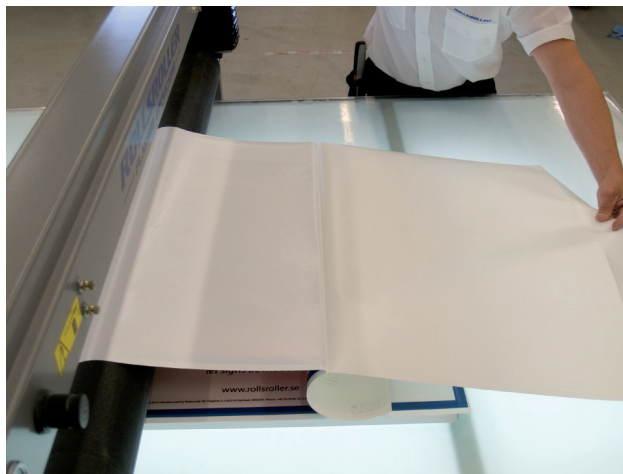
13. Applicare la parte rimanente dell'immagine sul supporto utilizzando il rullo. Ricordare sempre di sollevare leggermente il rullo nel momento in cui raggiunge il bordo.
