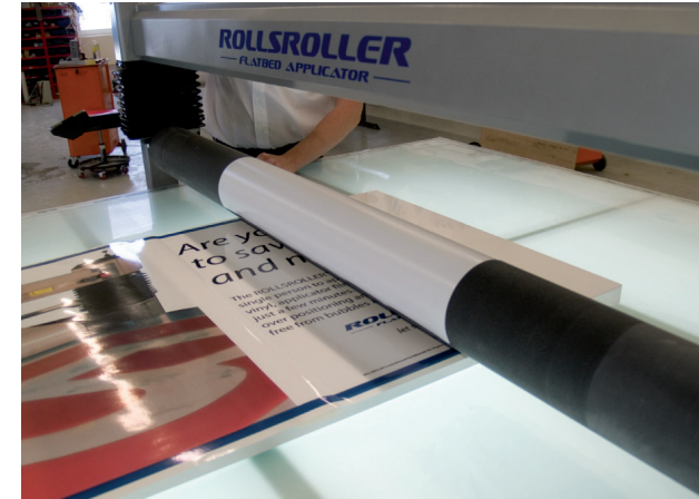
9. Walzen Sie nun die Dekorrhälfte ohne Schutzfolie auf der Unterlage fest. Beim Erreichen der Kante die Walze etwas anheben, so dass sie nicht über die Kante nach unten drückt. Achten Sie stets darauf, dass bei Beginn der Bewegung das Dekor sauber an der Walze anliegt.
