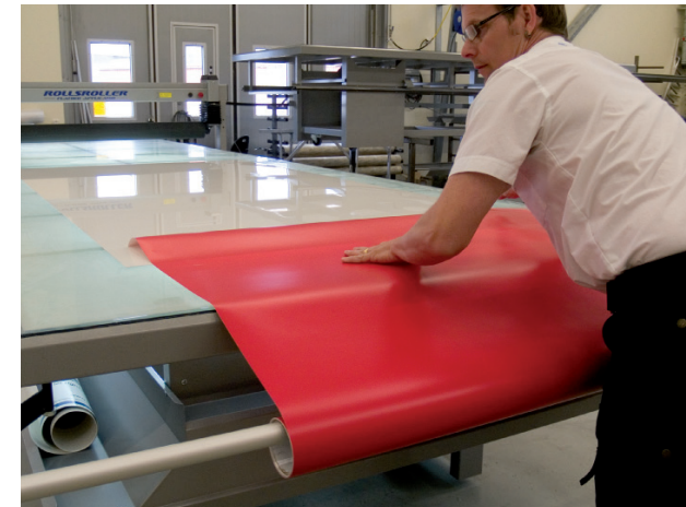
1. Das Trägermaterial zentrisch auf dem Tisch positionieren und Folie auflegen.
