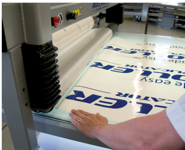
7. Læg printet ind mod appliceringstapen.
