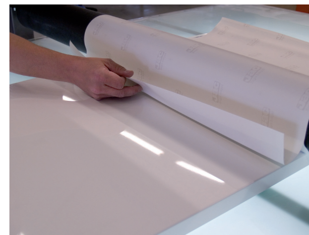
12. Agarrar el revestimiento doblado desde el otro lado. Mover la barra deslizante sobre la superficie. Comprobar siempre que la decoración está en contacto con el rodillo al arrancar.
