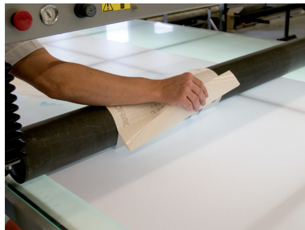
10. Agarrar la parte del revestimiento doblado debajo del rodillo.
