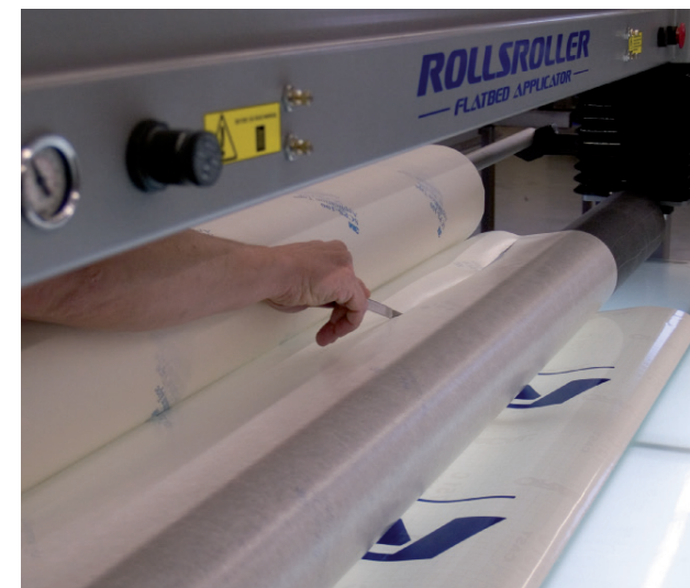
9. Tagliare il materiale prima di applicare l'ultimo pezzo di film. Se si sta stendendo dell'Application tape su diverse immagini allo stesso tempo, sollevare il rullo e ripetere allo stesso modo le prime operazioni descritte.
