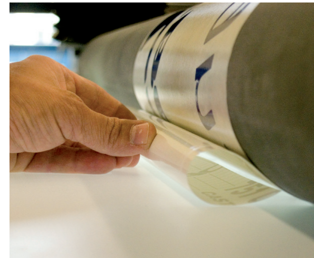
7. Den Überstand der Schutzfolie unter die Walze einstecken. Darauf achten, dass ein sauberer Bogen entsteht.
