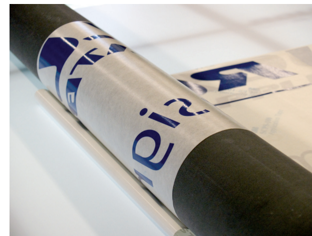
8. Applicera hälften av dekoren med hjälp av valsens. Tryck-sätt valsens mot underlaget.
