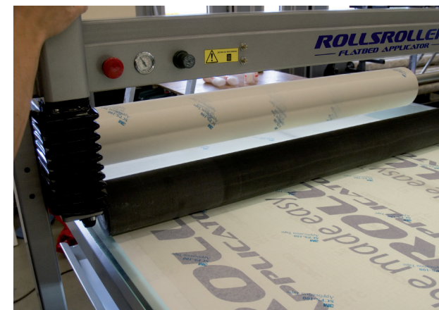
10. Hacer retroceder la barra deslizante, presurizar el rodillo y efectuar la última aplicación en sentido opuesto.
