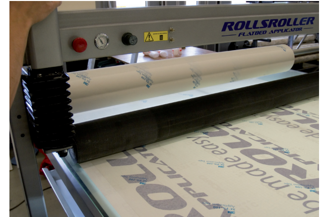
10. Führen Sie den Gleitbalken zurück, beaufschlagen die Walze mit Druck und fahren den letzten Auftrag in entgegengesetzte Richtung.
