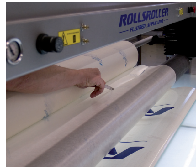
9. Skær af, inden du applicerer det sidste stykke tape. Hvis du skal applicere flere print samtidig, løfter du valsen og udfører samme startmoment, som du udførte på det første.
