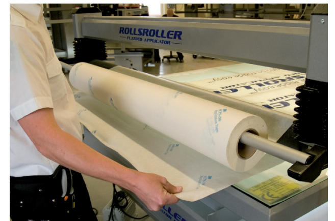
4. ... y colocarla canto a canto con el rodillo para asegurar una aplicación recta.
