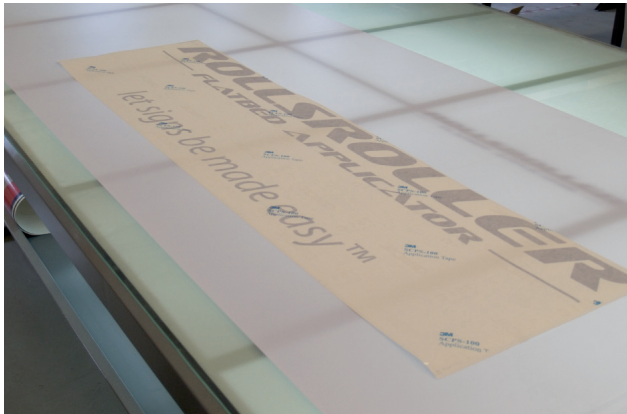
2. Anbring printet på underlaget, og placer det nøjagtigt efter målene.
